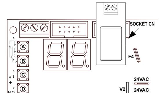
Il parametro **E1** abilita (**51**) o disabilita (**00**) il test delle fotocelle. Le impostazioni **(4.A)** e **(4.C)** richiedono **E1** impostato a **00**.
